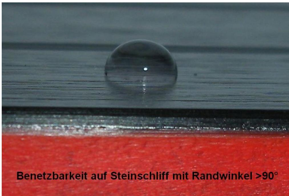
Abb. 5: Die geringe Benetzbarkeit einer ca. 3 Mikrometer dünnen Schicht von E-Indigo auf einer Skioberfläche mit Steinschliff, nachgewiesen mit der Form eines Wassertropfens. Je kugelförmiger der Tropfen, je größer der Randwinkel des Tropfens zur Oberfläche, desto geringer ist die Benetzbarkeit (Foto: Peter Bützer).
