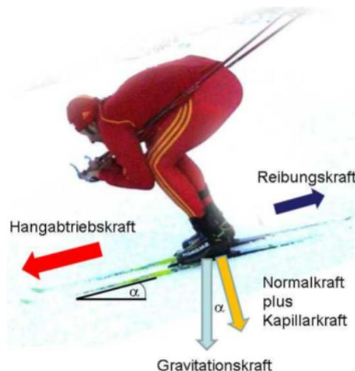
Abb. 3: Anteilige Wirkrichtung der Kapillarkräfte. Aus [14].
