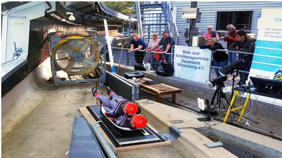
**Abb. 1:** Messaufbau. Zentral vor der Windmaschine befand sich der Schlitten auf der Druckmessplatte. Von der Seite verfolgte ein Videosystem die Vibrationen. Die maximale Windgeschwindigkeit betrug  $90\text{ km/h}$ .
