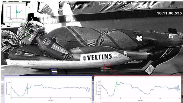
Abb. 3: Vibrationsmessungen am Rodel. Die beiden Diagramme zeigen die Vibrationsamplituden als Funktion der Zeit an den Verbindungsstellen von Wanne und Kufe.
