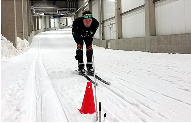
**Abb. 1:** Gleittest in Skihalle. Zu erkennen sind Start- und Zielreflektor sowie der optische Sensor an der rechten Wade des Testers.
