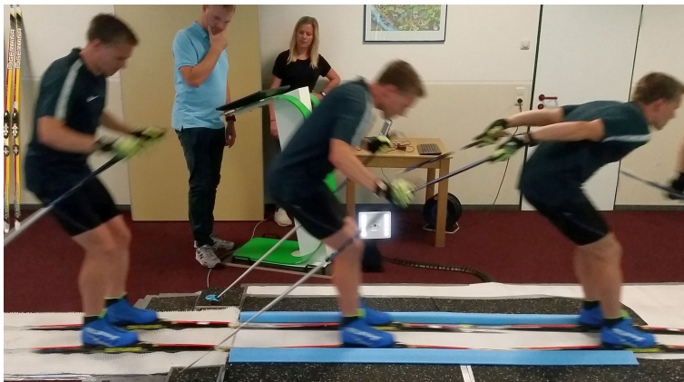
Abb. 2: Sequenz einer Fahrt über die Druckmessplatte. Der Athlet ist Thierry Langer von der belgischen Nationalmannschaft.
