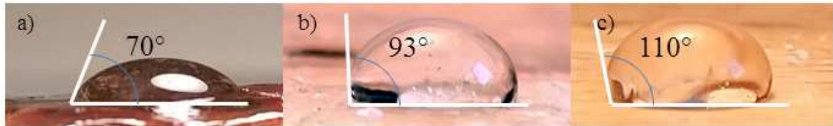
Bild 1: Benetzungswinkel auf a) Harz, b) Bienenwachs und c) Holmenkol MATRIX FX BLUE.
