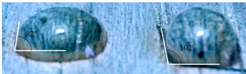
Bild 6: Links: Benetzungstest auf glatter Hickoryoberfläche. Rechts: Benetzungstest in einem Bereich, in dem freigelegte Porenkanäle liegen.
