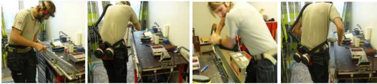
Bild 1: Skipräparation in der Reihenfolge Pulvern, Bügeln, Abziehen und Bürsten, Polieren.
