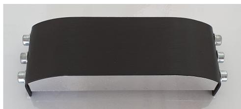
Abb. 1: Metallischer Probenschuh, bezogen mit UHMWPE-Belag.
